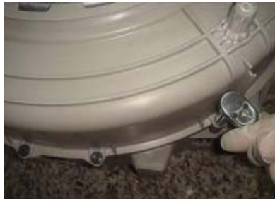
Dévisser les vis de fixation des ½ cuves
