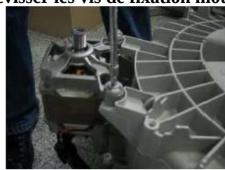
Dévisser les vis de fixation moteur
