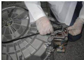
Dévisser les vis de fixation moteur
