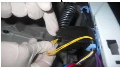
Débrancher le pressostat EPS
