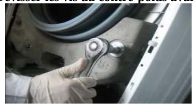
Dévisser l'écrou central fixation résistance (8mm)
