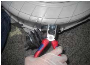
Dévisser les vis de fixation des ½ cuves
