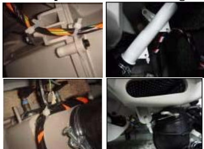
Enlever les clips de fixation amortisseur
