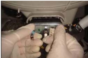
Dévisser les vis du contre-poids supérieur
