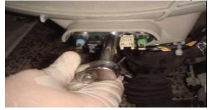
Démonter le collier joint de hublot
