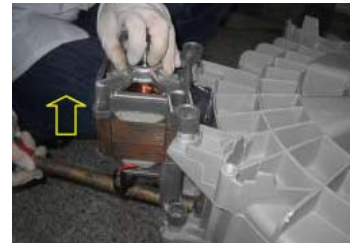
Démonter le moteur
