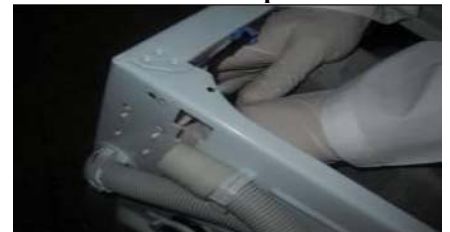
Enlever le collier du tuyau pressostat
