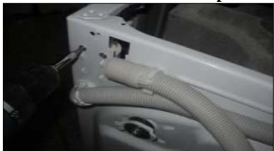
Débrancher le pressostat EPS
